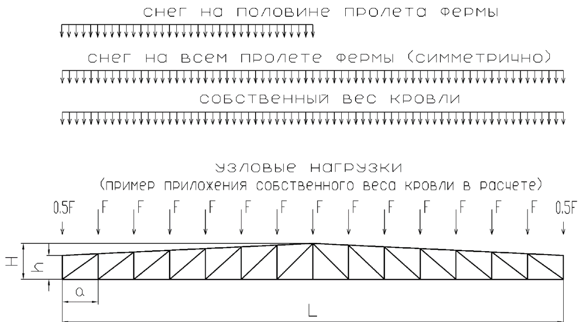
Рис. 3. Расчетная схема фермы и схемы нагрузок
