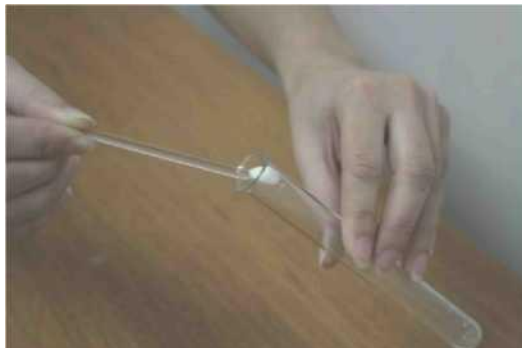
Рисунок 1.3 – Внесение в пробирку порошкообразных веществ
