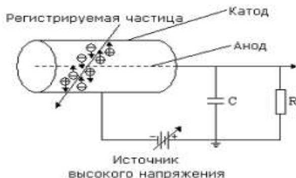
Рисунок 2. 4 – Принципиальная схема конструкции ГС
