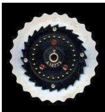
Рис. 3.4. Правая сторона ротора, видны штыревые контакты
