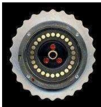
Рис. 3.3. Левая сторона ротора Энигмы, видны плоские электрические контакты
