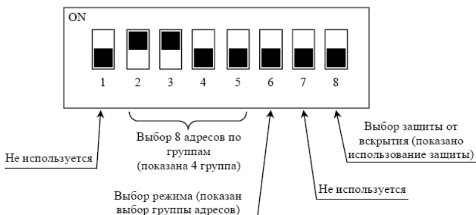
Рисунок 2. Назначение DIP-переключателей
