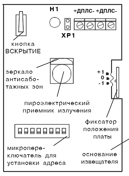
Рисунок 2. Печатная плата Вид сверху
