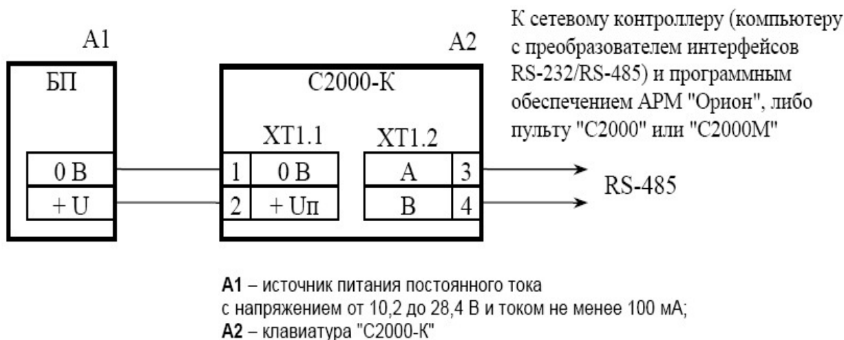
Рисунок 1. Схема подключения клавиатуры "С2000-К" при эксплуатации
