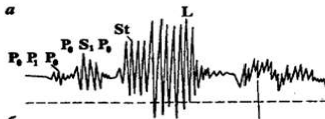
Рисунок 1 – Волновые картины в плотных (а) P_0P_1P_0 – головная продольная волна; P_0S_1P_0 – поперечная волна; St, L – волны Стоунли и Лэмба, P_0P_0 – отраженная волна
