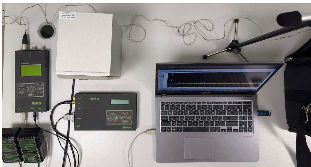
Рисунок 1 – Исходное положение комплекса «СПРУТ-МИНИ-А» при исследовании акустического канала утечки информации
