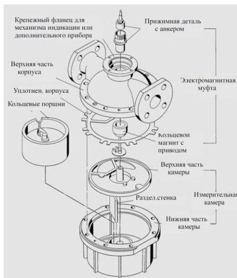
Рисунок 2 - Измерительный механизм кольцевого счетчика
