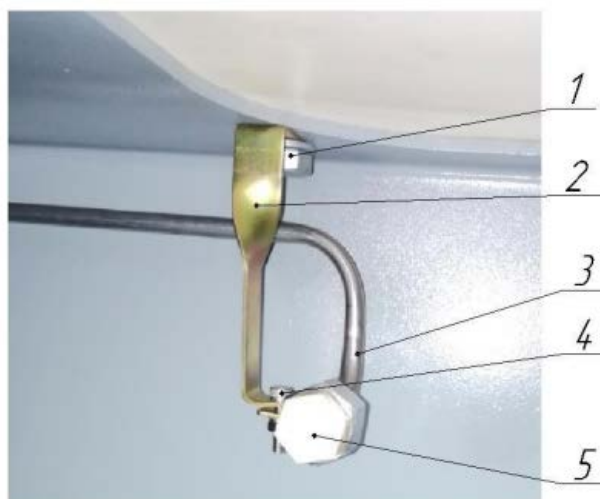
Рисунок 13 - Демонтаж транспортировочных деталей
