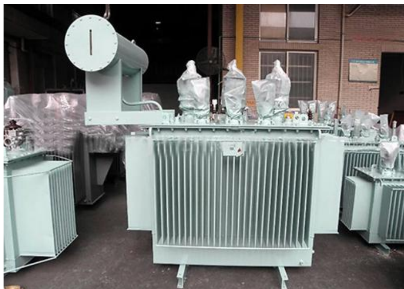
Рисунок 8 – Хранение трансформаторов в полностью собранном виде
