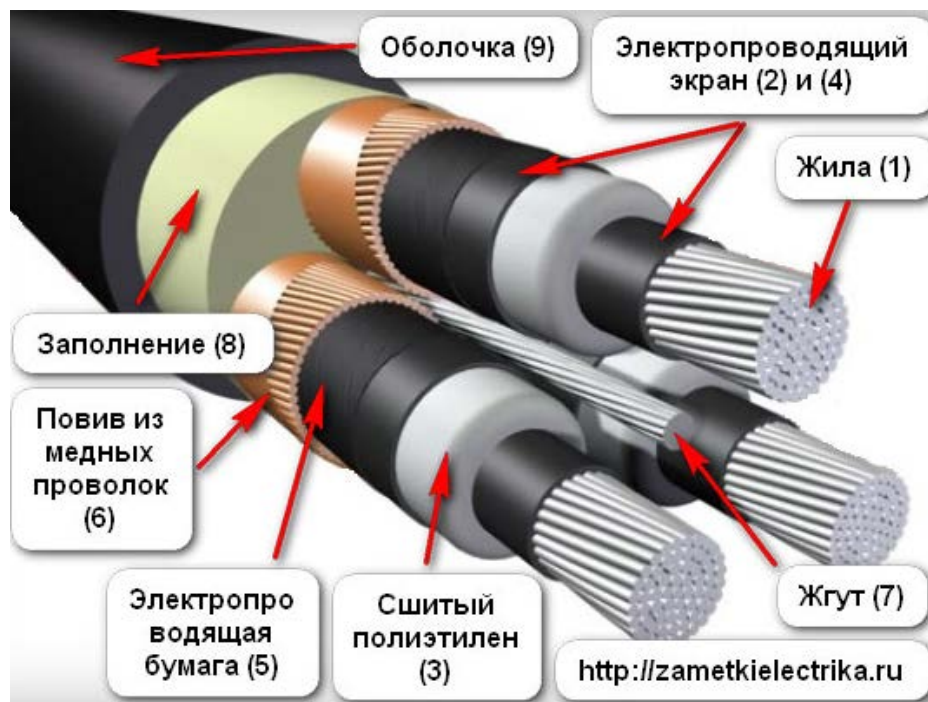
Рисунок 1 – Конструкция трехжильного кабеля СПЭ
