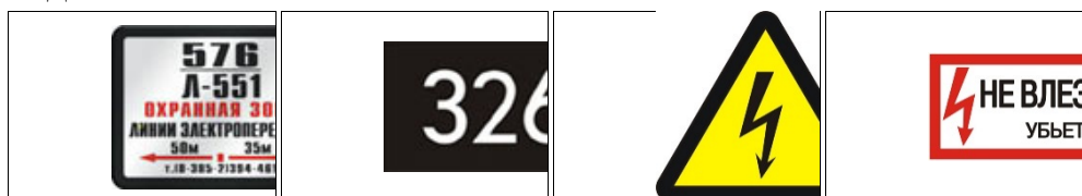
Рисунок 14 Знаки и плакаты применяемые на ВЛ.
