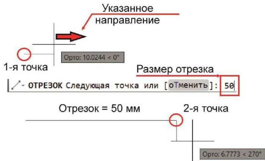
Рисунок 0.4 – Построение отрезка заданной длины
