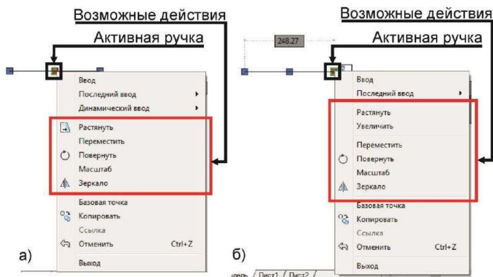
Рисунок 0.11 – Редактирование при помощи ручек
