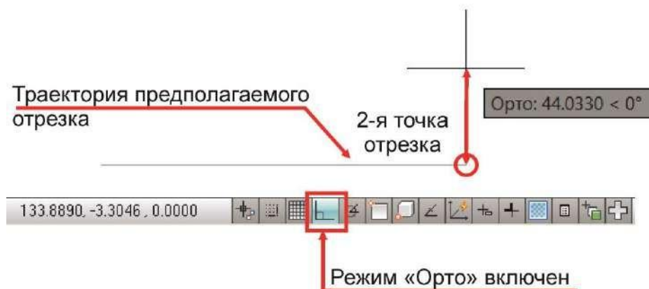
Рисунок 0.3– Построение отрезка в режиме «Орто»
