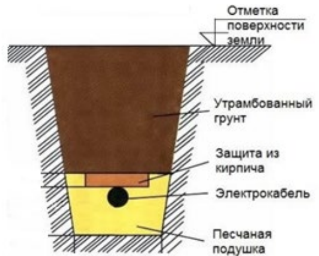
Рисунок – Прокладка кабеля в траншее
