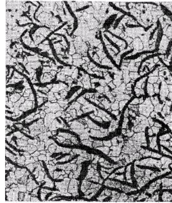
Рисунок 10. Микроструктура серого чугуна с ферритной металлической основой. X 200
