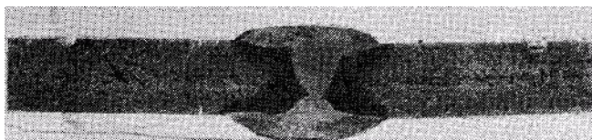
Рисунок 4. Химическая неоднородность сварного соединения
