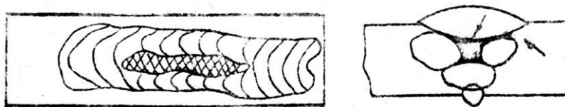
Рисунок 12. Шлаковые включения наружные и внутренние, неправильное перемешивание сварочной ванны, недостаточная зачистка промежуточных
