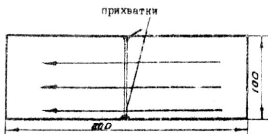
Рисунок 1. Схема прихватки и наложения валиков с различной мощностью пламени
