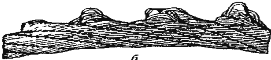
Рисунок 12 – Выдавливание проволок прядей:
