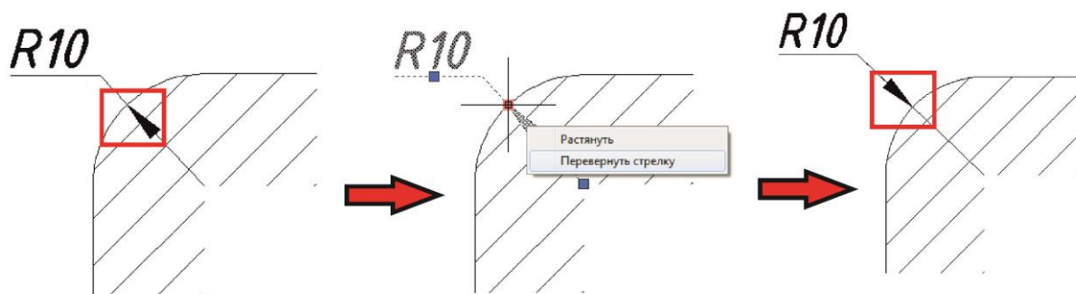
Рисунок 3.31 – Изменение направления стрелки
