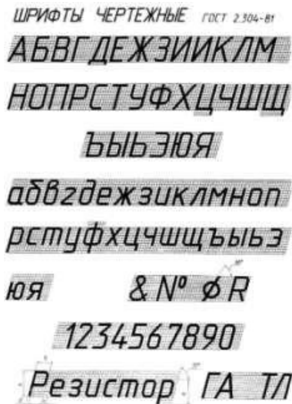
Рисунок 1 – Шрифт типа Б с наклоном 75°
