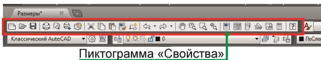
Рисунок 0.53 – Панель инструментов «Стандартная»
