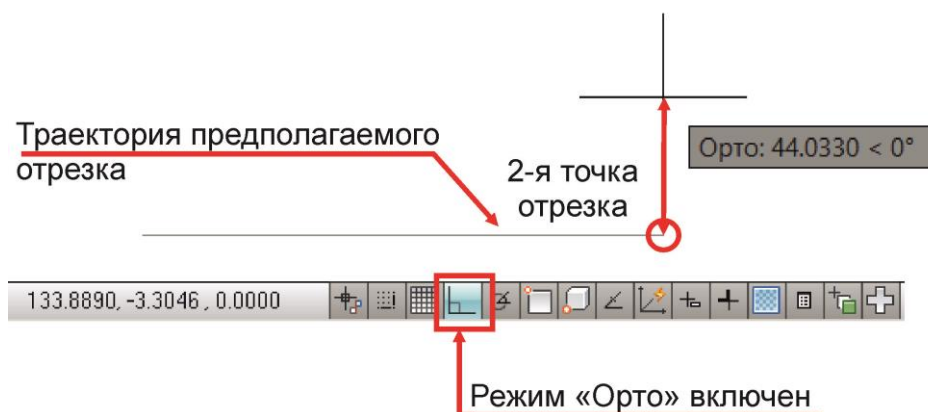
Рисунок 0.3– Построение отрезка в режиме «Орто»
