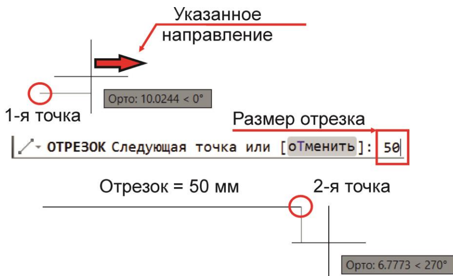
Рисунок 0.4 – Построение отрезка заданной длины
