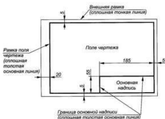
Рисунок 2 – Образование формата чертежа
