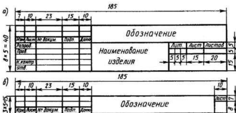
Рисунок 5.2 – Формы основной надписи для спецификации
