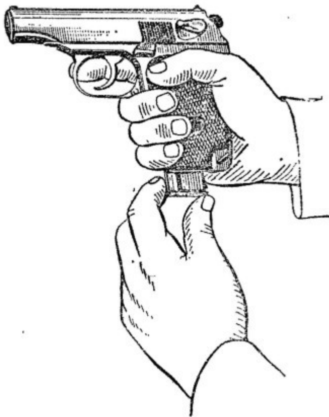
Рис. 8. Вставление магазина в основание рукоятки
