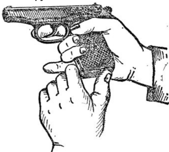
Рис. 3. Извлечение магазина из основания рукоятки
