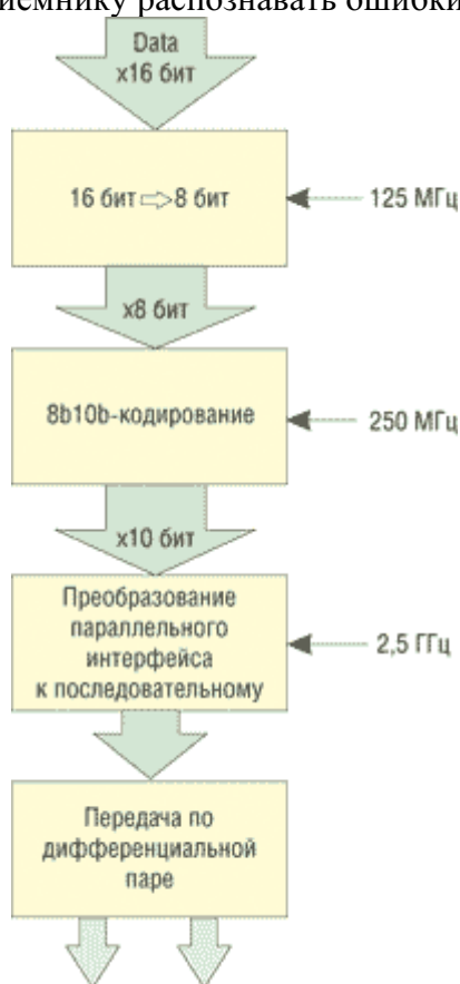
Рисунок 13 - Преобразование данных на физическом уровне при передаче
