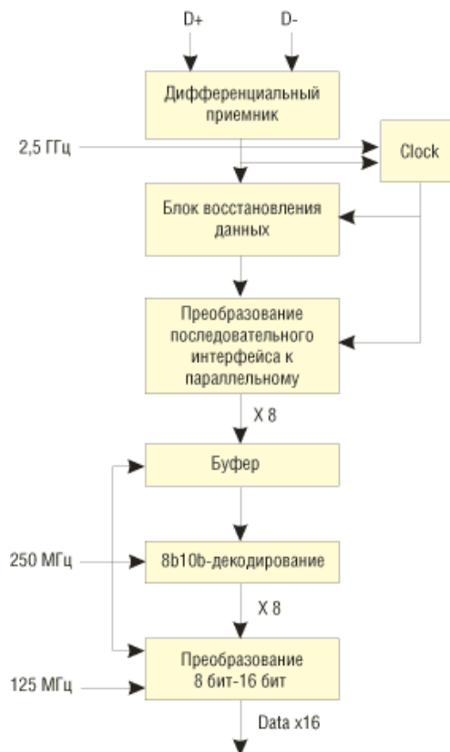
Рисунок 14 - Преобразование данных на физическом уровне при приеме
