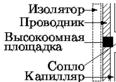
Рисунок 2 - Схема образования капель в струйном принтере фирмы HP
