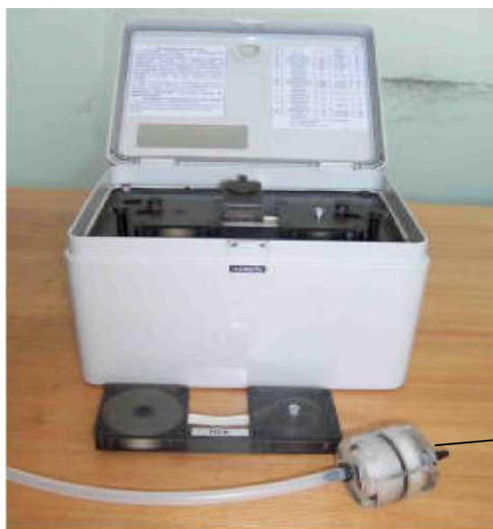
Рисунок 3.2 – Общий вид газоанализатора ГАНК-4
