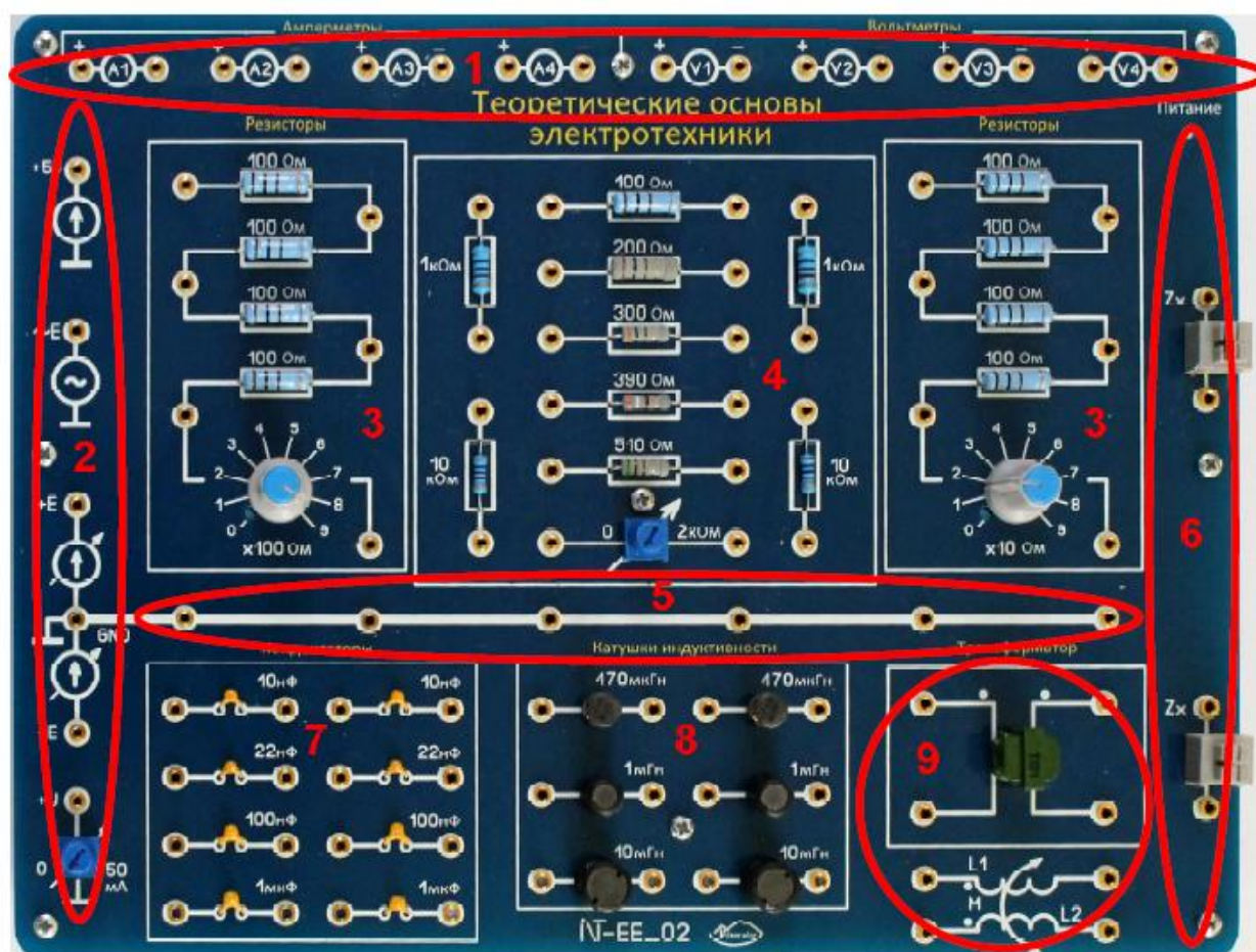
Рисунок 1.9 – Макетная плата и зоны элементов на ней
