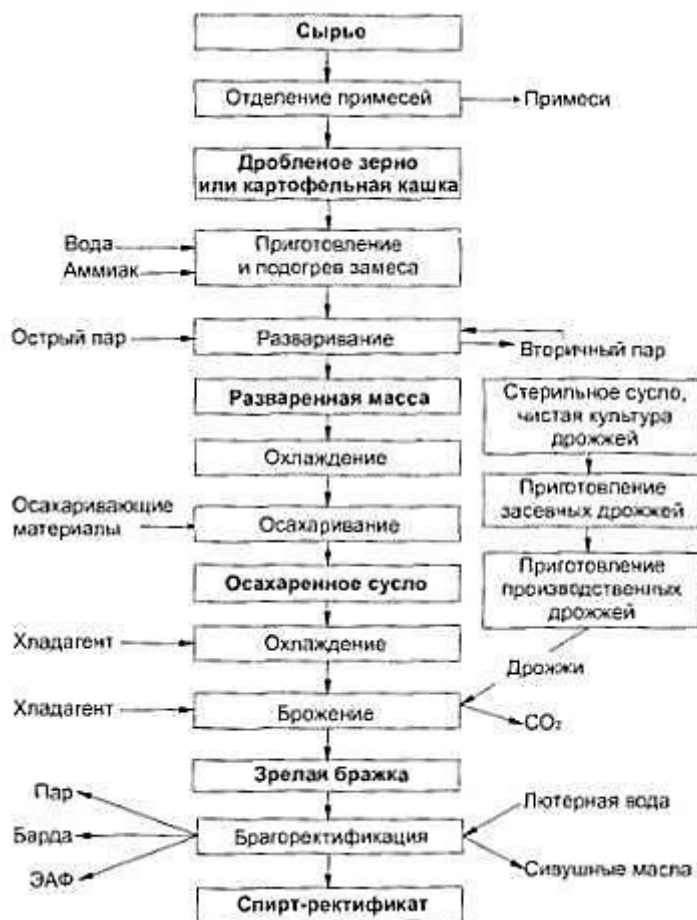
Рисунок 6 – Блок-схема производства этанола из зерна или картофеля
