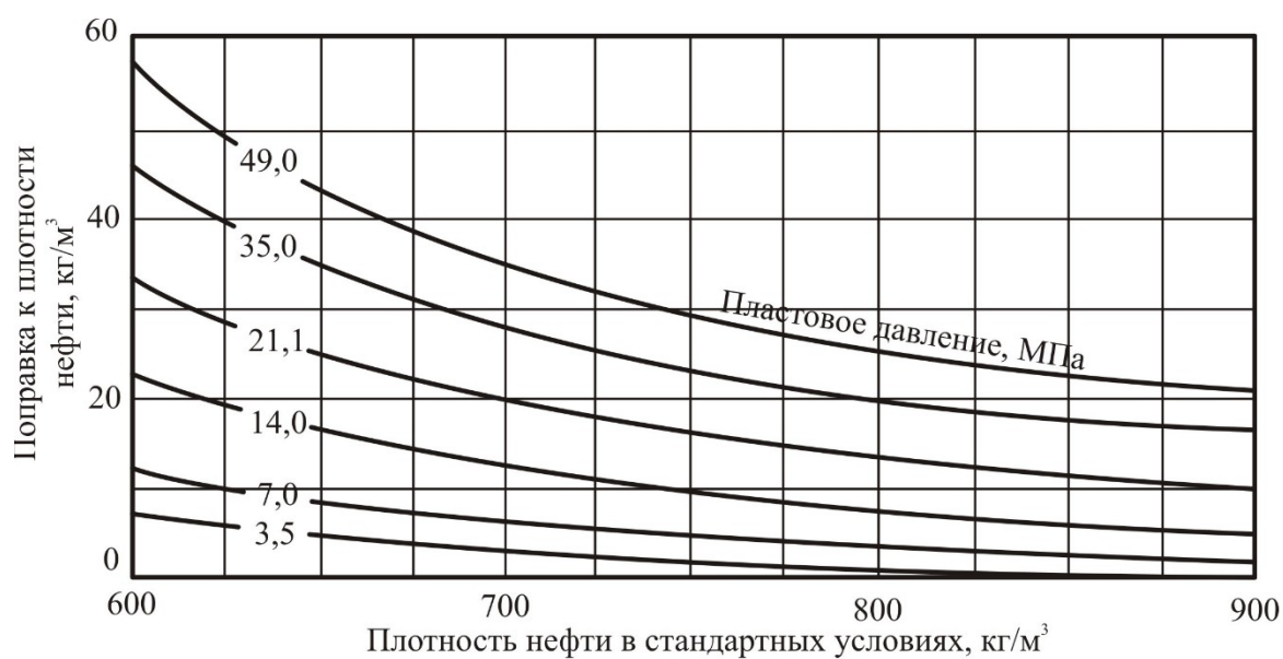
Рисунок 5.3. График зависимости \Delta\rho_P = f(\rho_{\text{н.ст}}; P_{\text{пл}})
