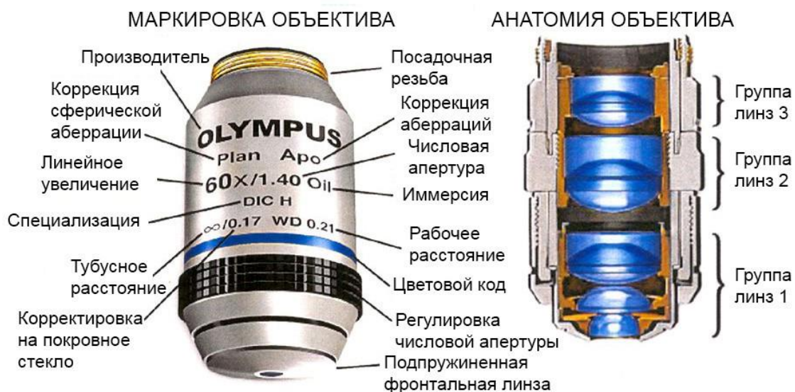
Рисунок 1.2 – Устройство объектива
