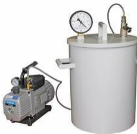
Рисунок 2 – Вакуумная установка ву-976а для водонасыщения образцов
