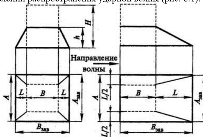
Рис. 6.1 – Расчетные схемы завалов при взрыве: а – внутри здания; б – вне здания; --- – контуры здания до разрушения; — — контуры завала
