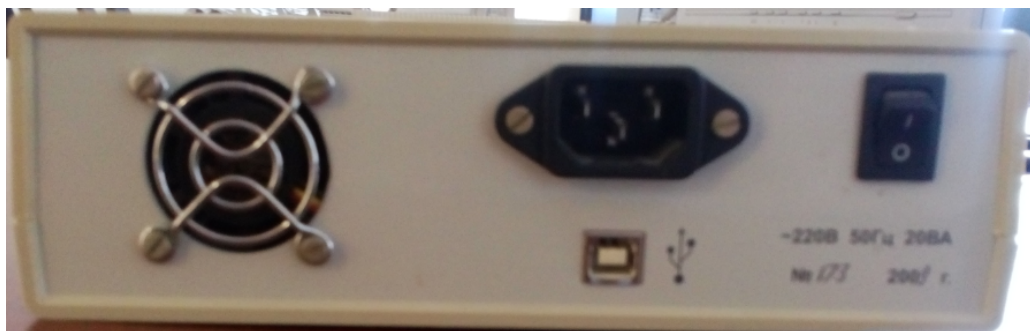
Рисунок 2 – Внешний вид блока АЦП осциллографического В-423 со стороны задней панели
