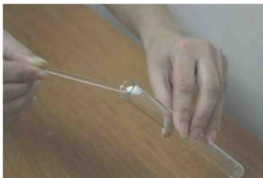
Рисунок 1.3 – Внесение в пробирку порошкообразных веществ
