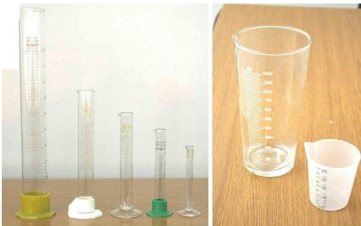
Рисунок 1.10 — Мерные цилиндры ( а ) и мензурки ( б )
