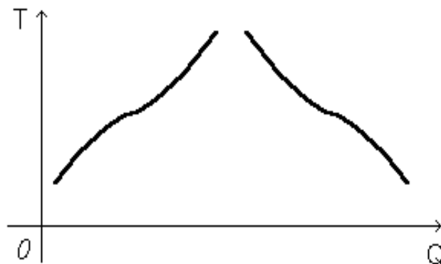
Рис. 4. Кривые плавкости аморфного тела.
