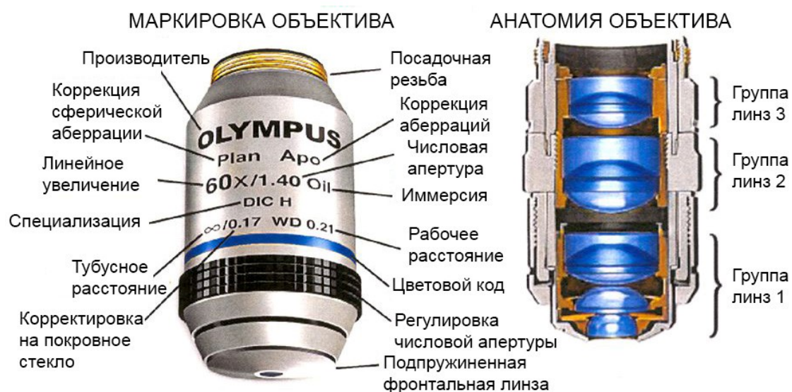
Рисунок 2 – Устройство объектива
