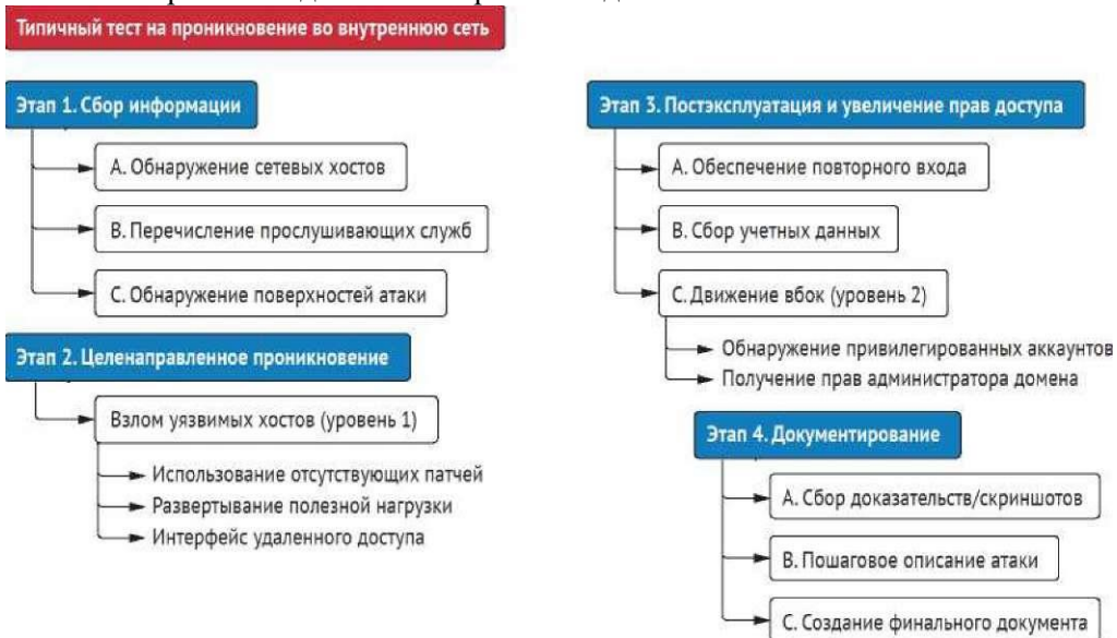
Рис. 1.1 Четыре этапа теста на проникновение в сеть
