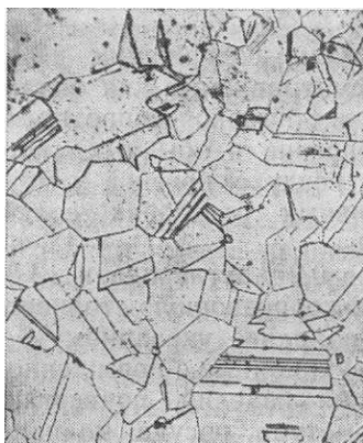
Рисунок 3. Микроструктура стали 12X18H9T (аустенит, карбиды титана). X200
