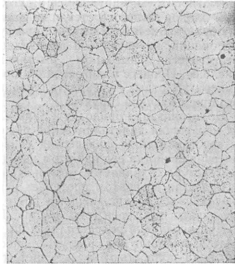
Рисунок 6. Микроструктура рекристаллизационного технического железа. X200
