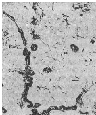
Рисунок 2. Микроструктура литой стали 110Г13Л (аустенит, карбиды). X200
