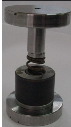
Рисунок 6.4 – Устройство для заневоливания внутренней пружины клапана двигателя автомобилей семейства ВАЗ в сборе
