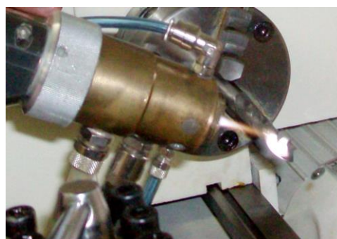
Рисунок 7.12 – Финишное плазменное упрочнение сверла
