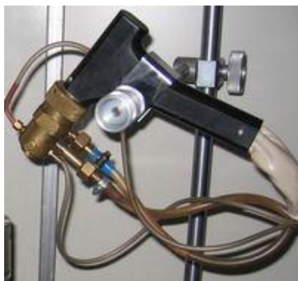
Рисунок 7.2 – Плазмотрон с плазмохимическим генератором
