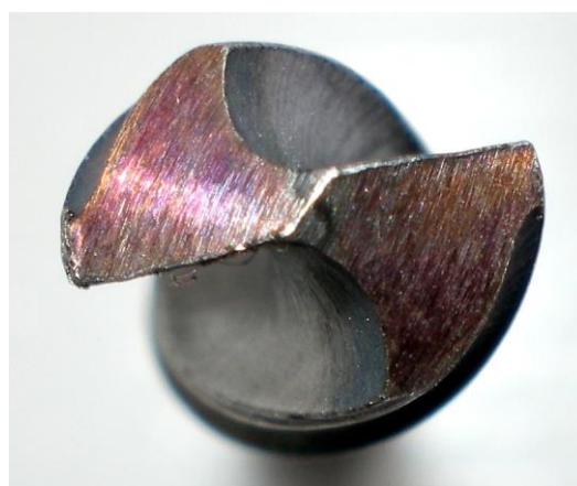
Рисунок 7.14 – Износ режущих кромок сверл: а) – не подвергнутого ФПУ; б) – подвергнутого ФПУ
