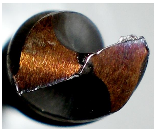
Рисунок 7.14 – Износ режущих кромок сверл: а) – не подвергнутого ФПУ; б) – подвергнутого ФПУ
