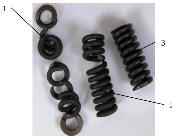
Рисунок 6.1 – Дефектные пружины гидрозамков подъёмника:
