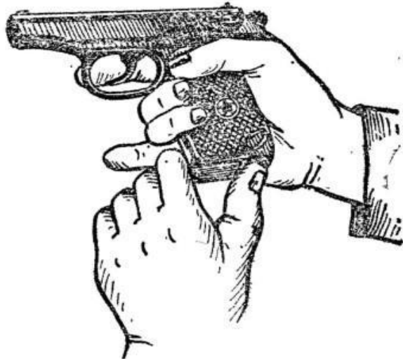
Рис. 3. Извлечение магазина из основания рукоятки
