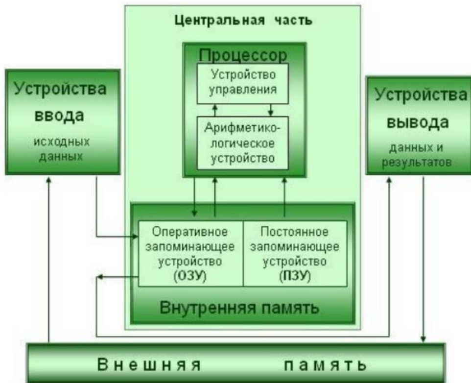
Рисунок 1. Общая схема компьютера
