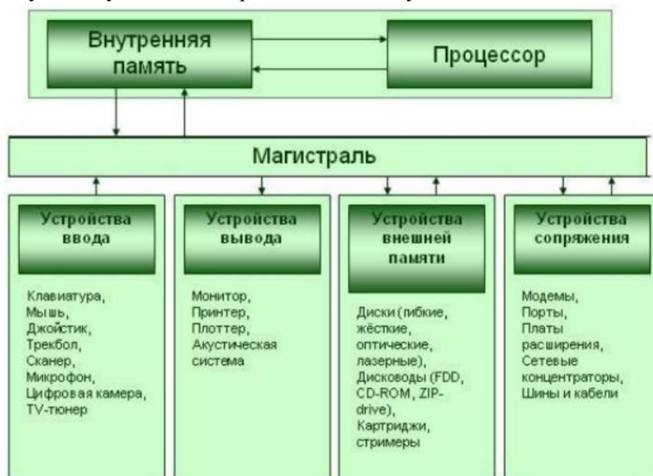
Рисунок 2. Магистрально – модульный принцип
