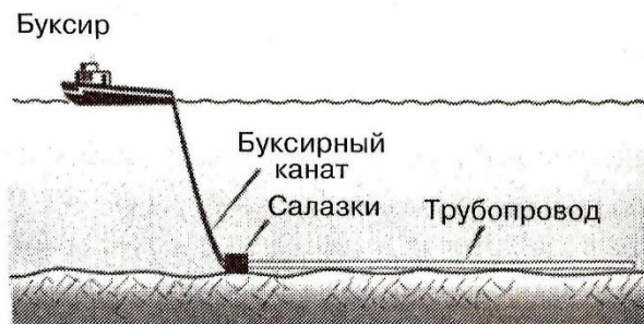
Рисунок 8 - Технологии буксировки и монтажа трубопровода
