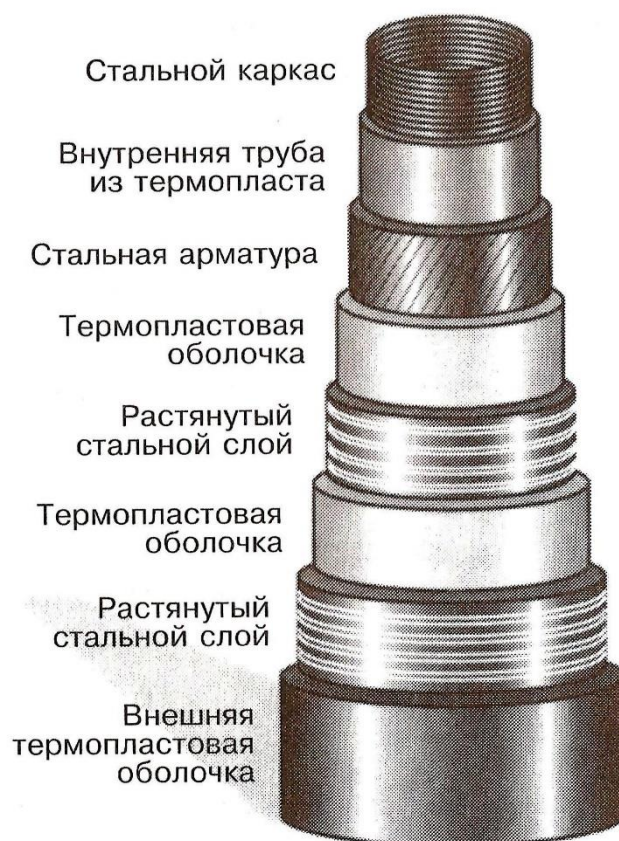
Рисунок 1 - Конструкция гибкого трубопровода
