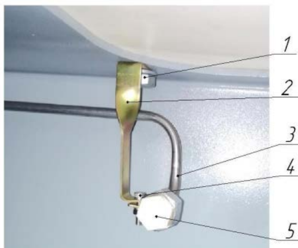
Рисунок 13 - Демонтаж транспортировочных деталей
