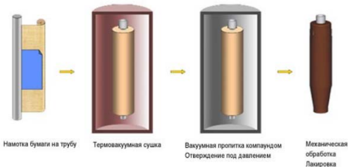
Рис.1 RIP-изоляция высоковольтного ввода
