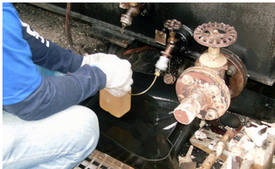
Рисунок 13 – Отбор пробы трансформаторного масла
