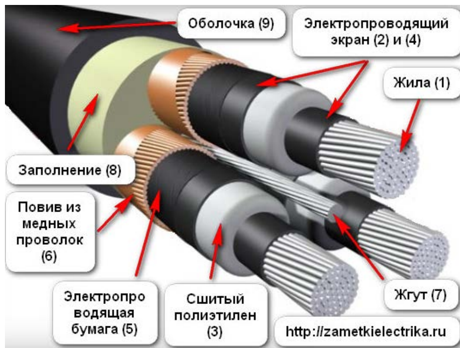
Рисунок 1 – Конструкция трехжильного кабеля СПЭ
