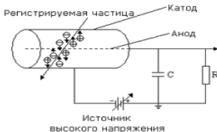
Рисунок 2. 4 – Принципиальная схема конструкции ГС
