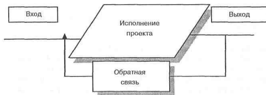
Рис. 7.1. Система управления с обратной связью
