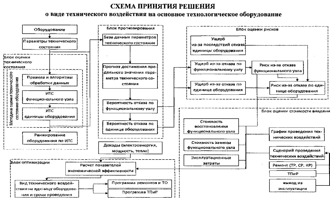
Рисунок 15.1 – Схема порядка принятия решения о виде технического воздействия на основное технологическое оборудование
