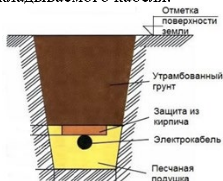
Рисунок 6.3 – Прокладка кабеля в траншее
