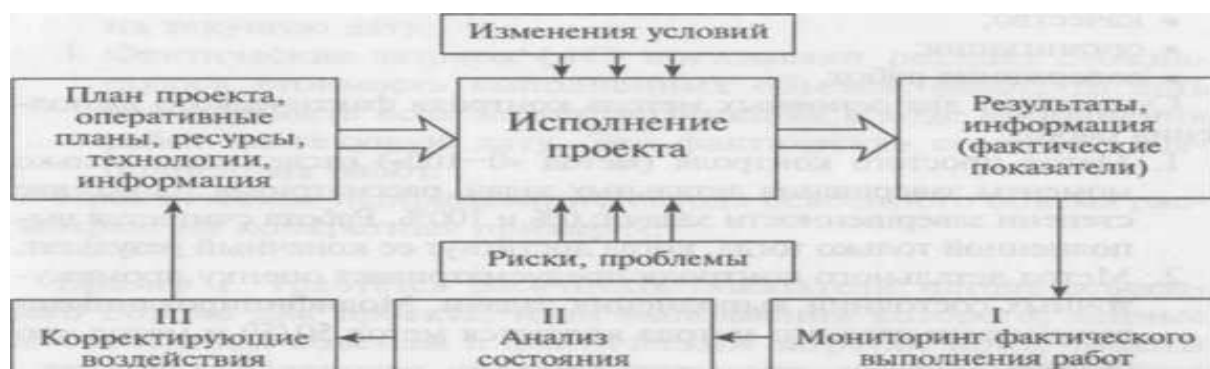
Рис. 13.1. Схема процесса управления исполнением проекта (контрольный цикл)
