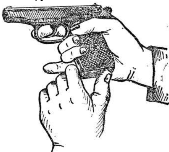
Рис. 3. Извлечение магазина из основания рукоятки
