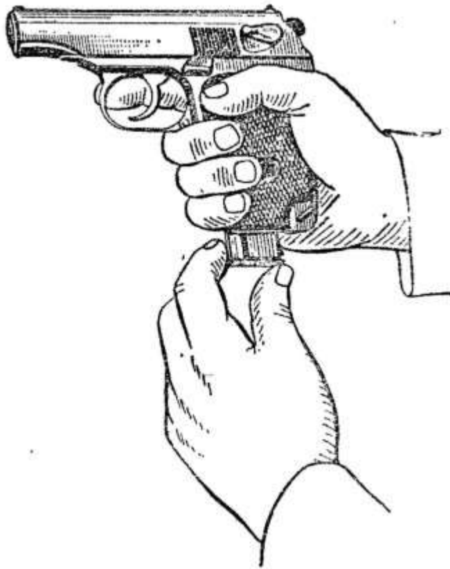
Рис. 8. Вставление магазина в основание рукоятки
