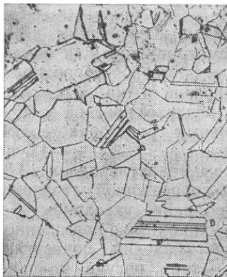
Рисунок 3. Микроструктура стали 12X18H9T (аустенит, карбиды титана). X200
