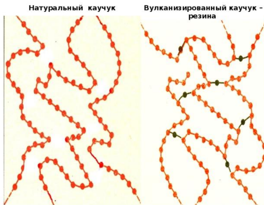
Рисунок 3 – Точки скрепления при вулканизации каучука
