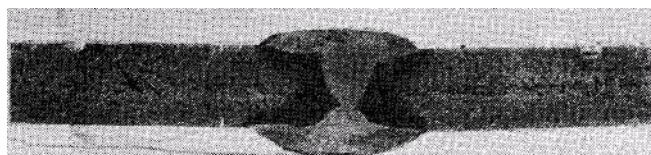
Рисунок 4. Химическая неоднородность сварного соединения
