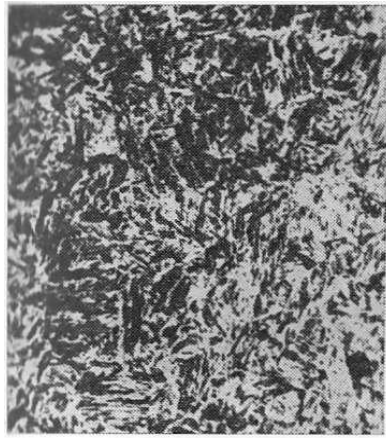
Рисунок 5. Мартенсит закалки в доэвтектоидной стали. X600
