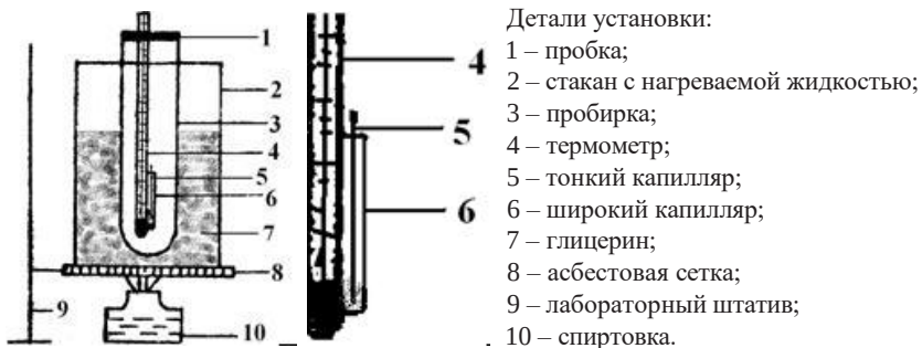
Рис. 2. Прибор для определения температуры кипения
