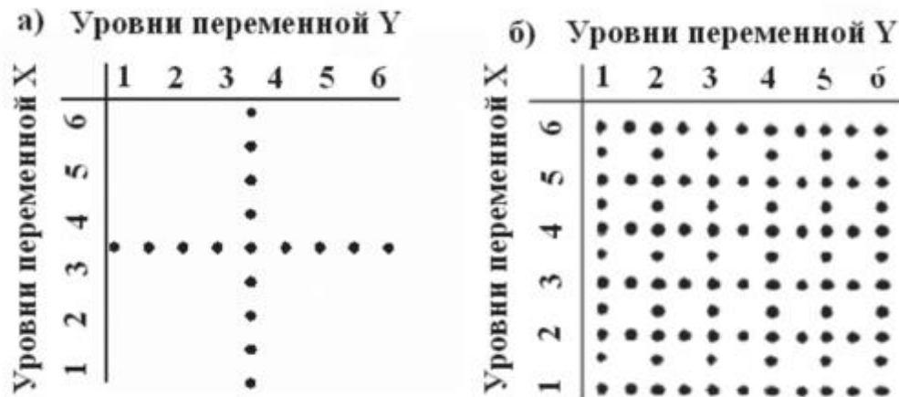
Рис. 1.2. Планы эксперимента: а — двухфакторного; б — многофакторного
