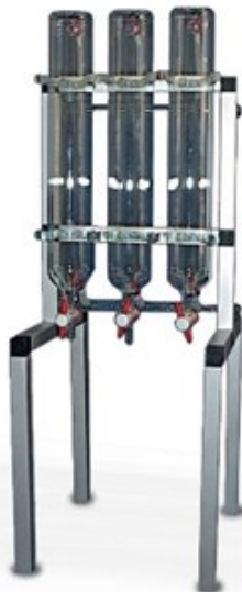
Рисунок 2. Термостатируемая установка для определения плотности Techno-glas
