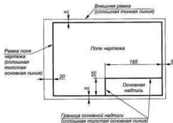
Рисунок 1.1 – Образование формата чертежа Таблица 1.1 – Основные форматы
