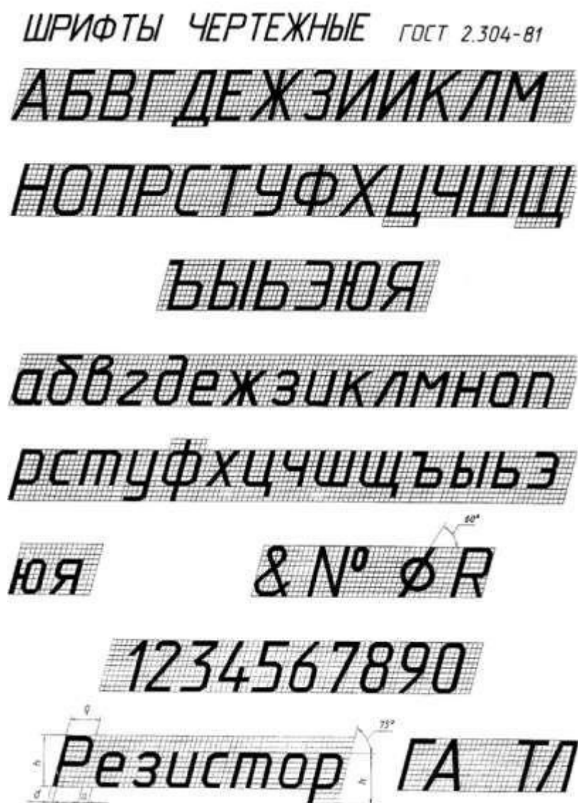
Рисунок 1.1 – Шрифт типа Б с наклоном 75°
