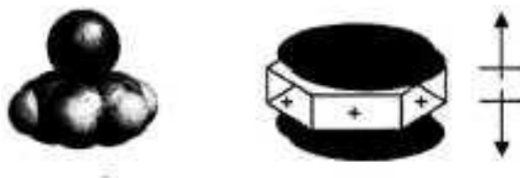
Рисунок 5 - Схематическое изображение катион- \pi -взаимодействия. Справа показан квадрупольный момент бензола, который представлен в виде двух противоположно направленных диполей
