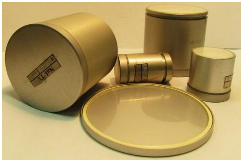
Рисунок 3.10 - Внешний вид сцинтиллятора (йодистый натрий, активированный таллием)
