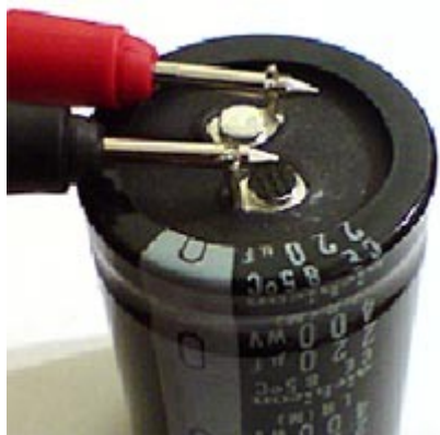
Рисунок 1.9 – Как необходимо прозванивать конденсатор
