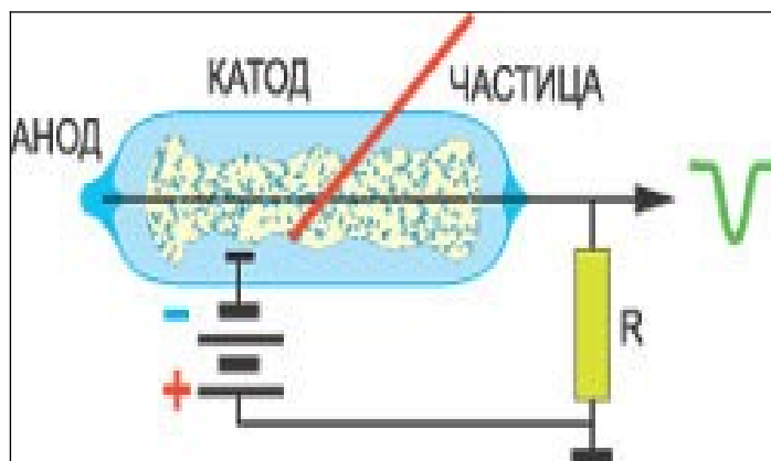
Рисунок 3.3 – Принципиальная схема газонаполненного детектора ионизирующего излучения
