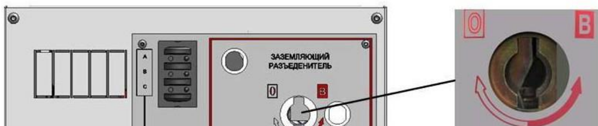
Рисунок 8 Блокировка, предотвращающая включение заземляющего разъединителя во включенном состоянии аппарата
