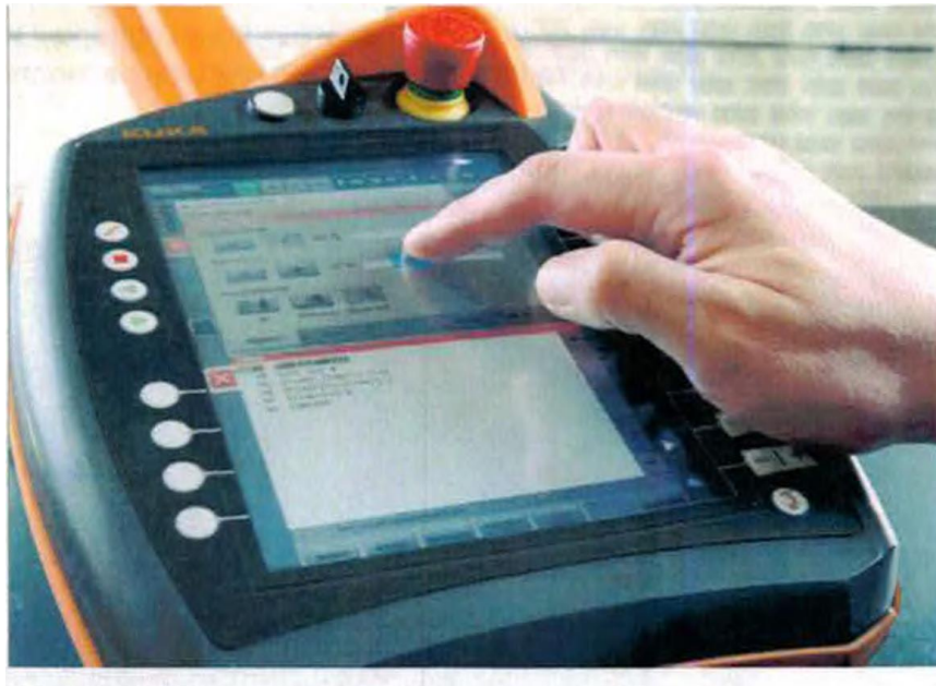
Программирование робота с помощью пульта KUKA smartPAD
