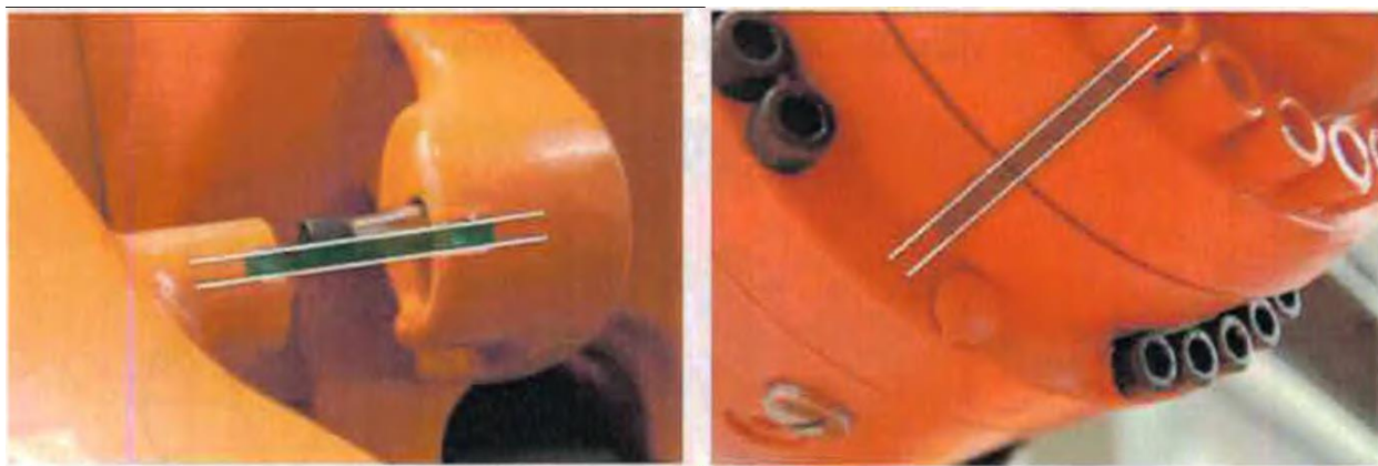
Рисунок 8 – Примеры предъюстировочного положения
