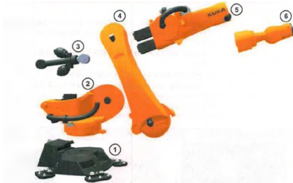
1 – Станина; 2 – Карусель; 3 – Компенсатор веса; 4 – Балансир; 5 – Манипулятор; 6 – Рука Рисунок 4 – Обзор компонентов механики робота
