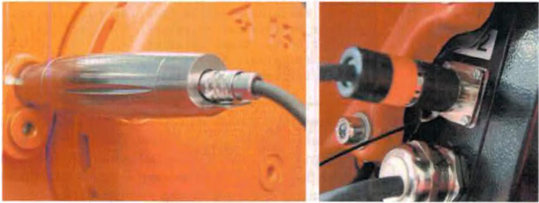
Рисунок 11 – Провод EMD, подключенный
