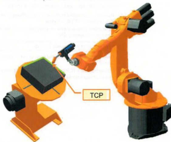
Рисунок 13 – Программный режим с TCP
