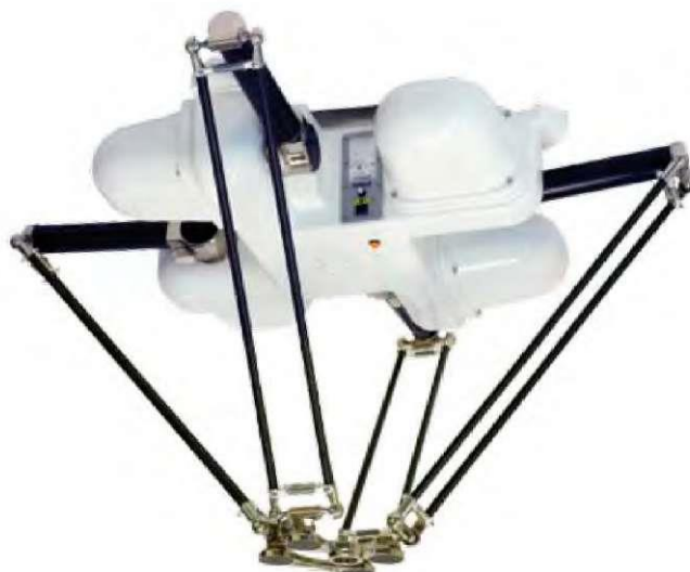
Рисунок 7.3 - Параллельный робот (дельта-робот)
