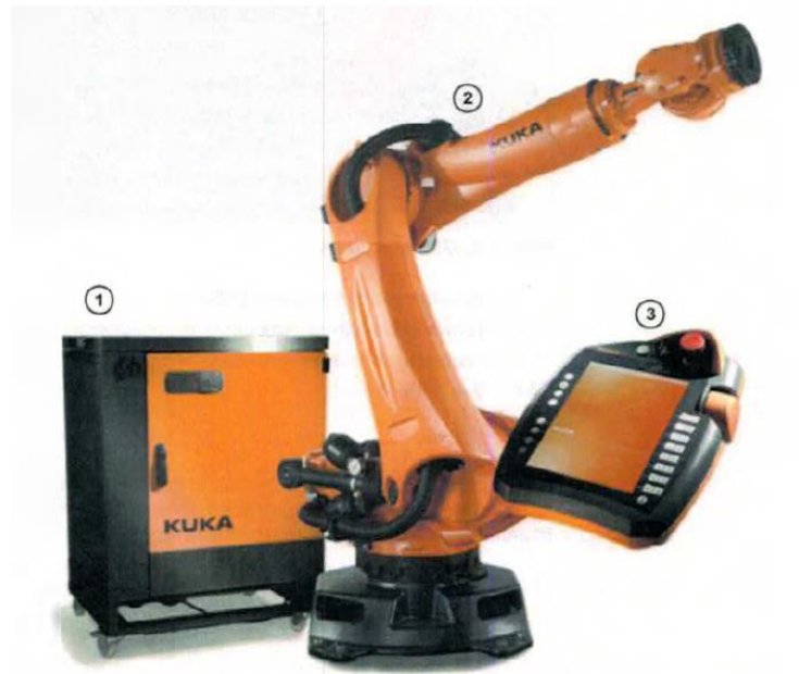
1 – Устройство управления (УУ); 2 – Исполнительное устройство (ИУ) (Манипулятор); 3 – Пульт управления и программирования
