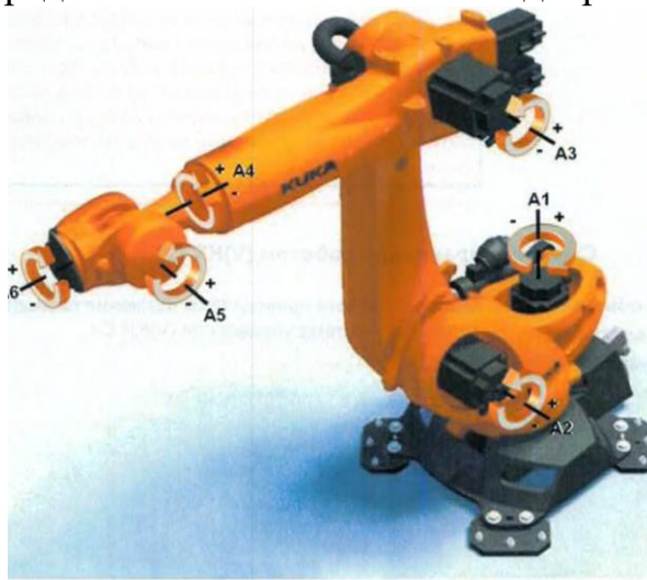
Рисунок 3 – Степени свободы робота KUKA
