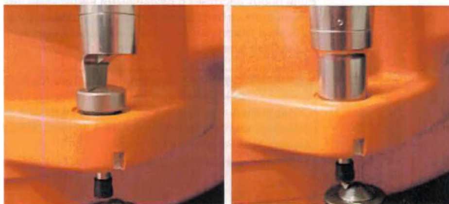
Рисунок 10 – Привинченное к измерительному патрону устройство EMD
