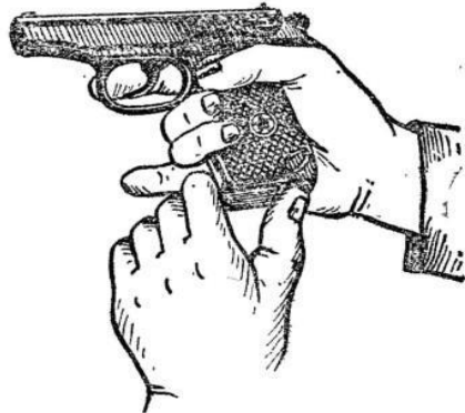
Рис. 3. Извлечение магазина из основания рукоятки
