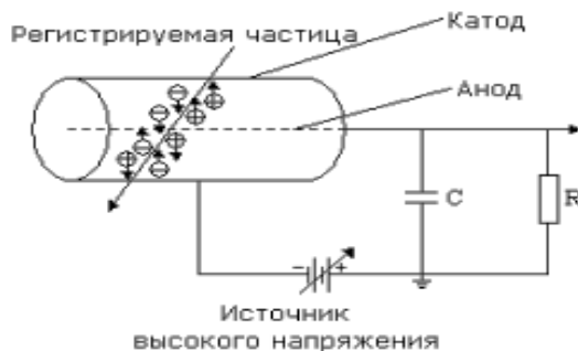
Рисунок 2. 4 – Принципиальная схема конструкции ГС
